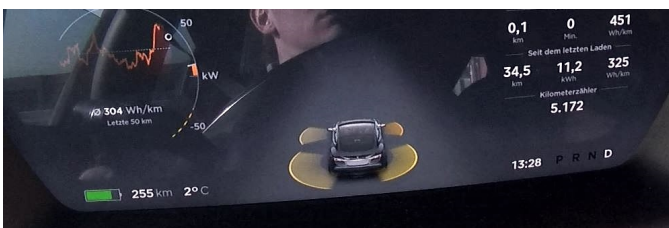
Abbildung 12. HMI des Tesla Model S 60D Facelift: Die gelben Bereiche nahe der Räder kennzeichnen, dass dort ein Hindernis erkannt wird. Eine Fahrbahnmarkierung ist nicht vorhanden und wird daher auch nicht visualisiert.
