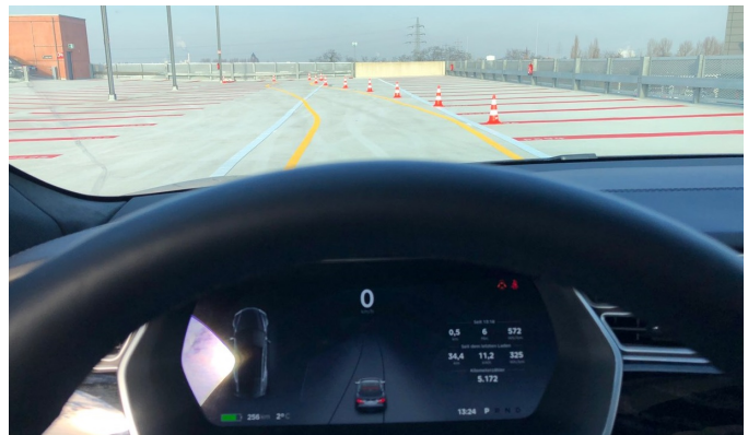
Abbildung 11. Gelbe Fahrbahnmarkierungen und Pylonen leiten von weißen Fahrbahnmarkierungen ab.
