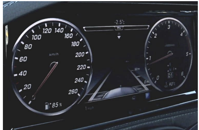
Abbildung 13. HMI des Mercedes-Benz S 350d: Bei aktiver Lenkunterstützung werden die Linien grün dargestellt. Dies ist während den Testfahrten nicht der Fall.
