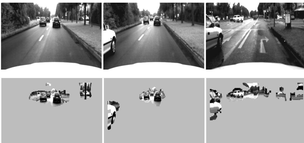
Abbildung 5.13: Segmentierung durch Sensorfusion mit einem Multilayer Perceptron. Drei Ergebnisbilder aus einer Stadtszene im Kreuzungsbereich.
