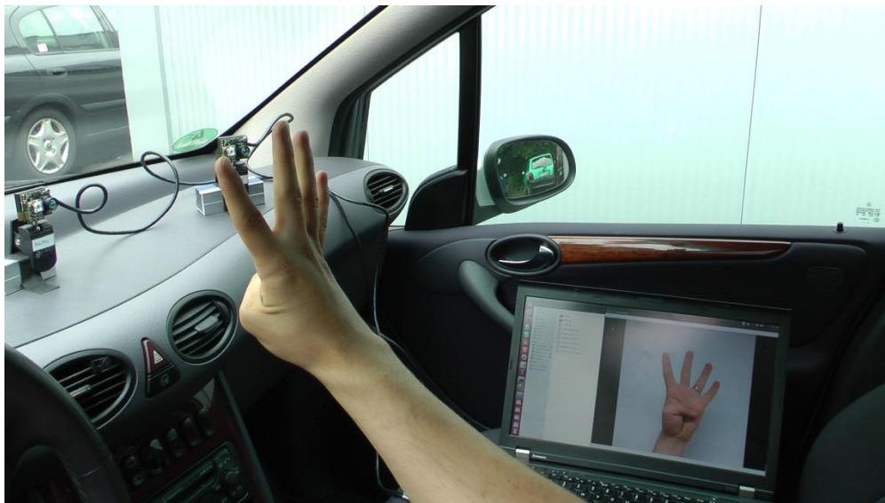
Abbildung 3: Gestenerkennung im Fahrzeug (Testsystem)
