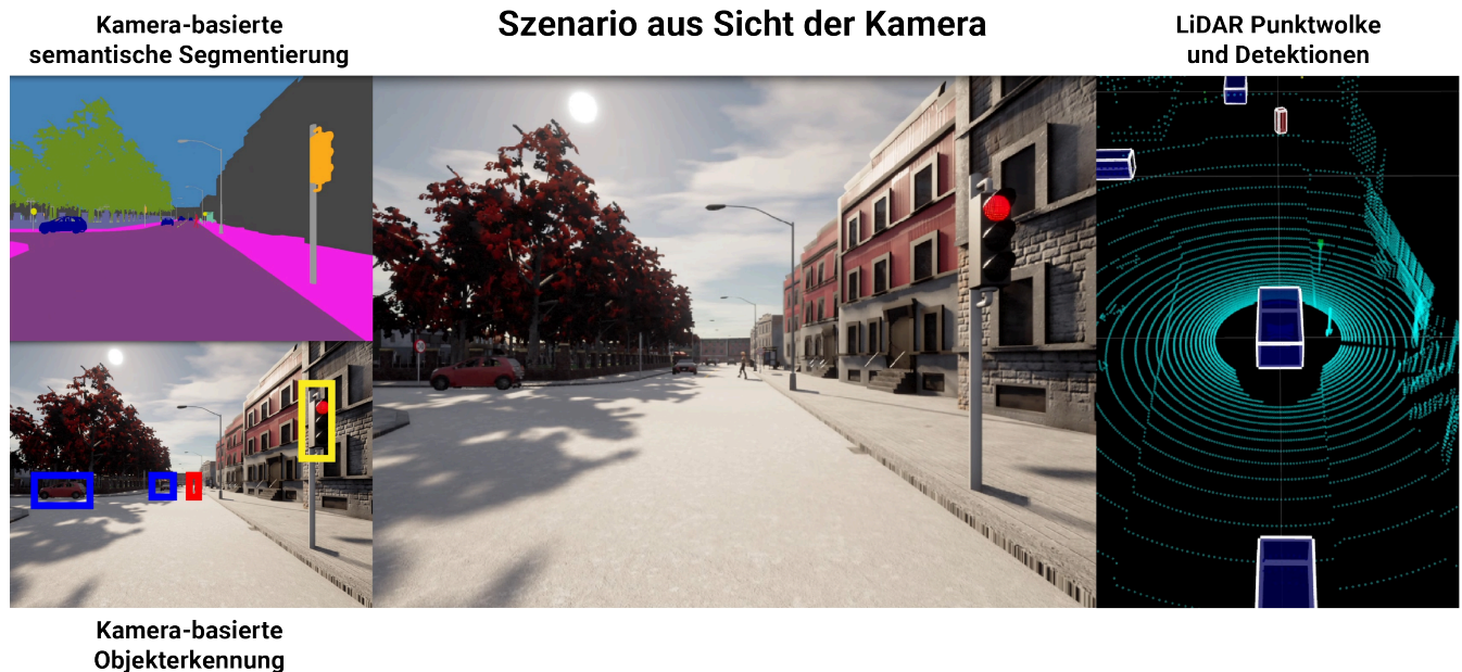
Abbildung 5: Darstellung der Sichtweise verschiedener Sensorik und der jeweiligen KI-basierten Systeme für die Umfelderkennung. Quelle: Eigene Darstellung. Bildmaterial: Dosovitskiy et al. 2017.
