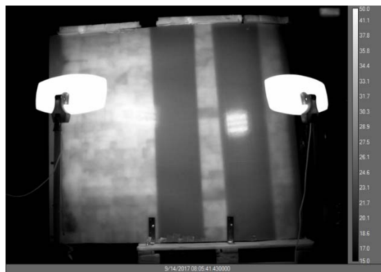
Abbildung 30: Standardaufbau Aufnahme mit der Langwellekamera
