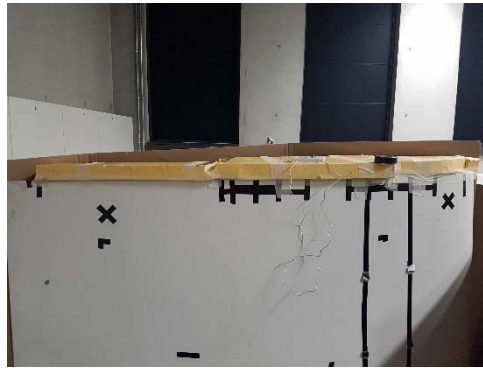
Abbildung 12: Abdichtung auf dem Flügelstück
