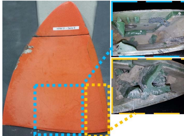
Abbildung 18: Charakteristiken in der Spitze; blau: typ 10 Schaden; orange: unsaubere Verklebung an der leading edge
