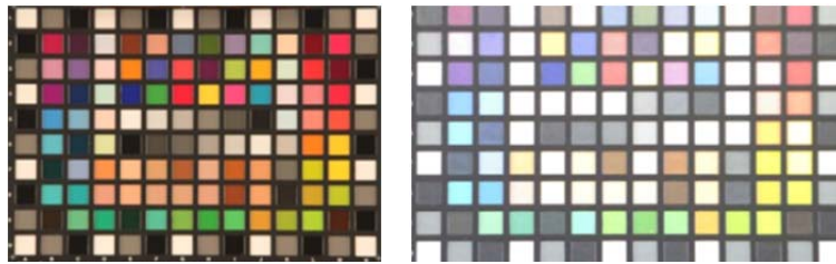
Abbildung 3: Digital ColorChecker SG: Unterschiedliche Farbdynamik verschiedener Kameras.
